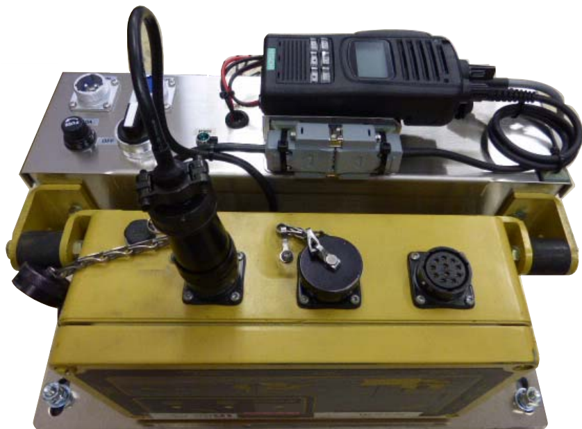
バックフォー及びブルドーザ制御部 (ステンレス・アルミ製)
